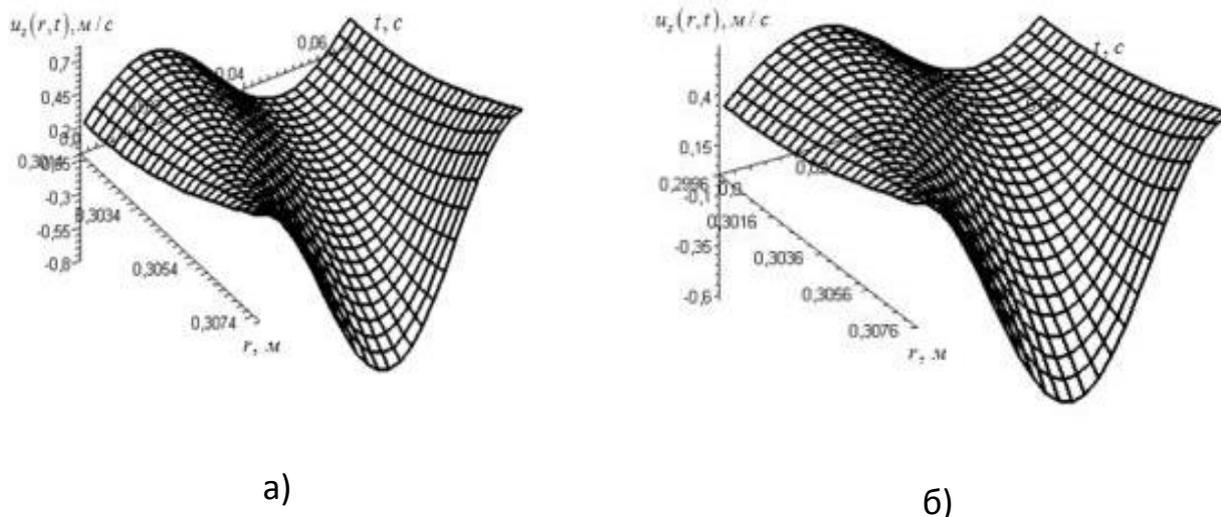
Рис. 2 – Поверхность скорости потоков, при: а)  $A^* = 0,006$  м,  $\omega = 96,9$  с<sup>-1</sup>; б)  $A^* = 0,008$  м,  $\omega = 75,9$  с<sup>-1</sup>
