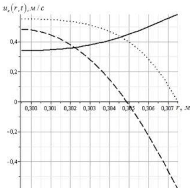
Рис. 3 – Профили скорости потоков зерновой смеси пшеницы по толщине слоя в различные моменты времени: —  $t = 0$ ; .....  $t = \frac{\pi}{2\omega}$ ; - - -  $t = \frac{\pi}{\omega}$  при  $A^* = 0,006$  м и  $\omega = 96,9$  с<sup>-1</sup>
