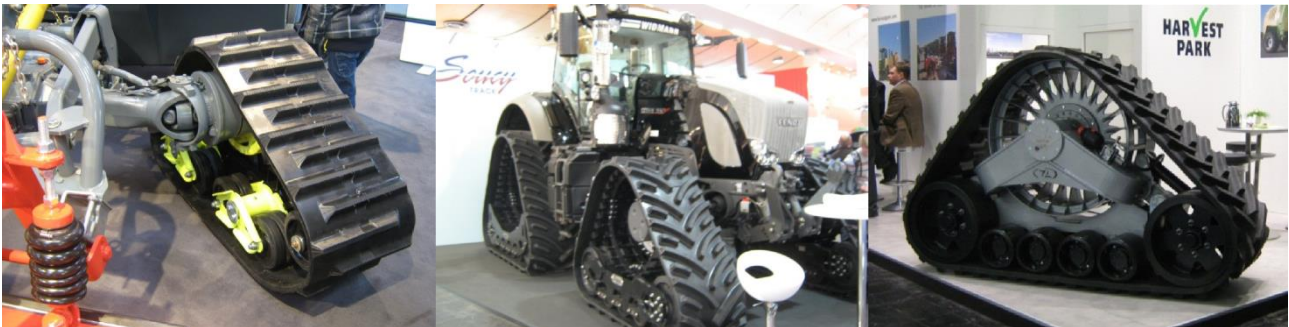
Рис. 4 – Гусеничні теліжки, що встановлюються замість коліс на колісній трактора класичної схеми
