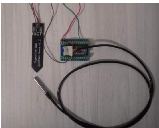
Рисунок 2 – Зібраний прототип для вимірювання температури та вологості ґрунту
