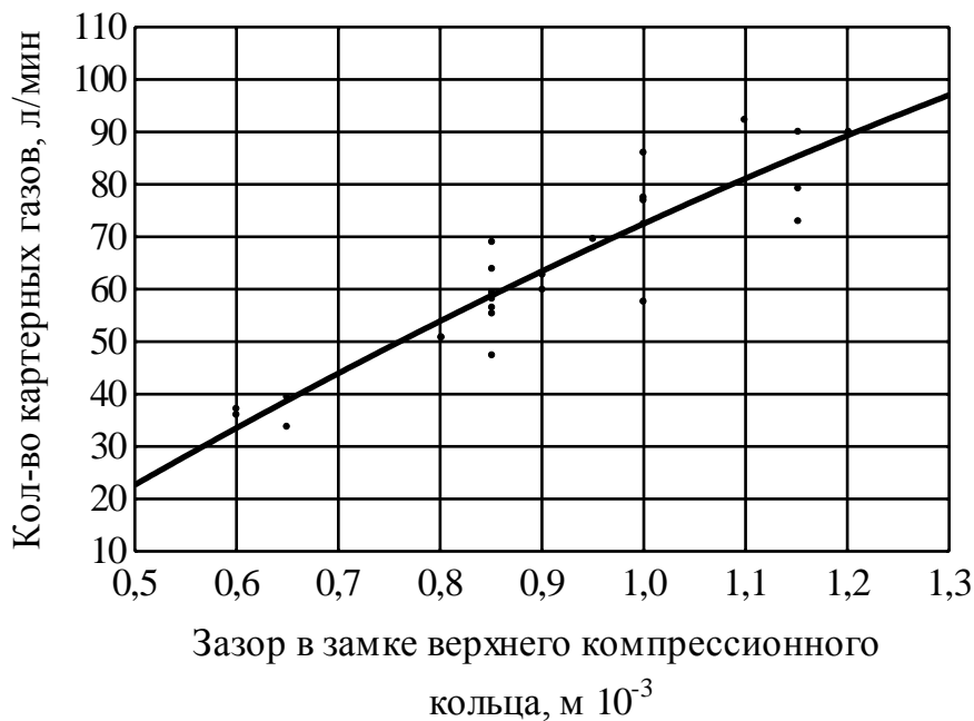
Рис. 1 – Зависимость между износом компрессионных колец и количеством картерных газов
