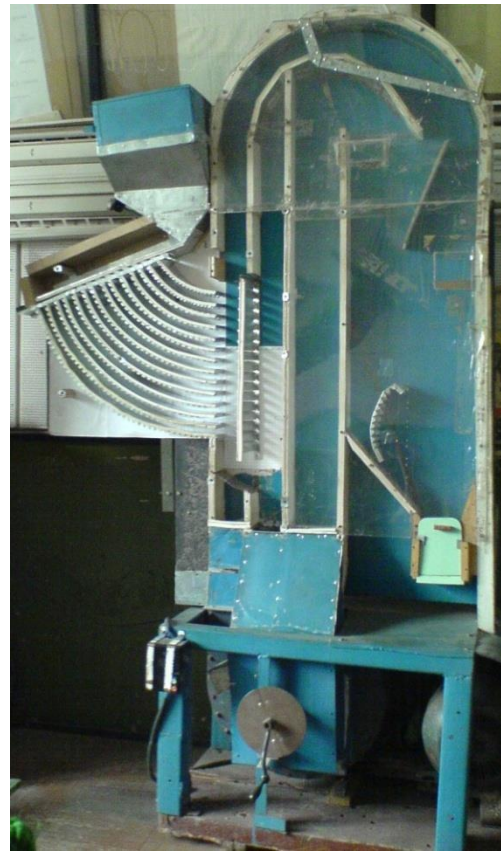
Рис.1 – Установа для дослідження ПСК з багаторівневим живильним пристроєм. а) – схема; б) – загальний вигляд.
