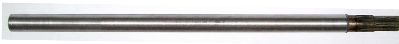
Рисунок -2. Пояса измерения коэрцитивной силы на подготовленном к наплавке образце
