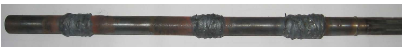
Рисунок -3. Пояса измерения коэрцитивной силы на наплавленном образце
