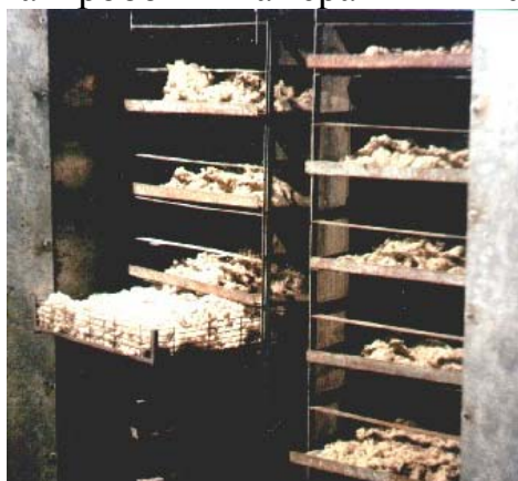
Рис. 8. Сушіння вовни в камері КС-1
