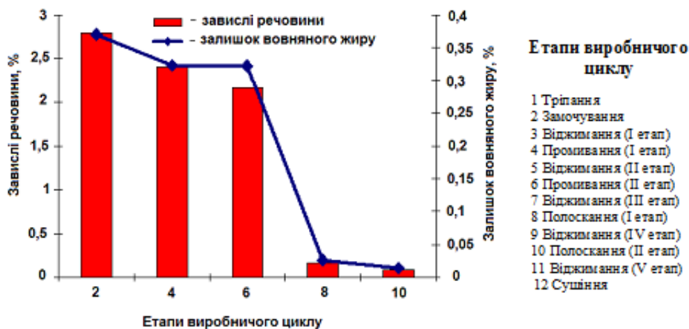
Рис. 13. Кінетика зміни якості очищення миючого розчину за етапами виробничого циклу
