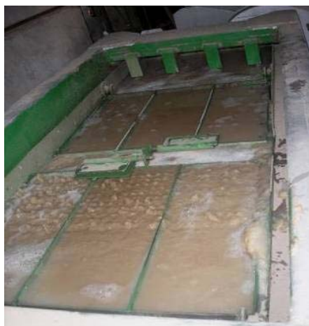
Рис. 6. Промивання вовни на МВМ-0,24 з поетапним віджиманням
