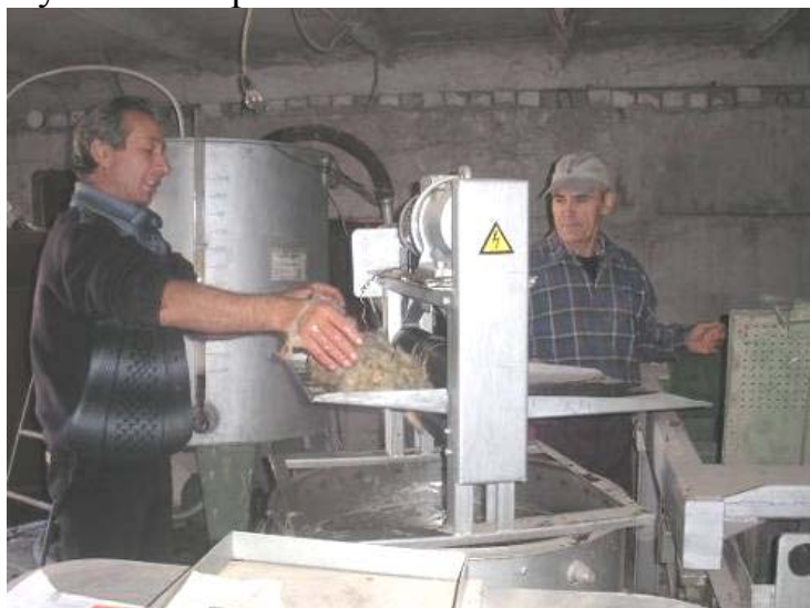
Рис. 5. Віджимання вовни на УВП-8,0 після замочування
