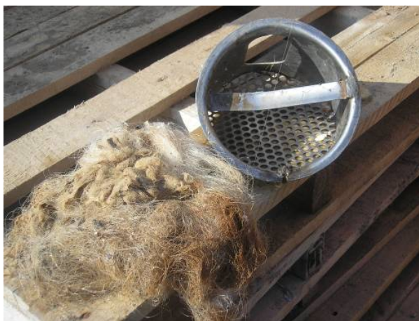
Рис. 10. Удосконалений проточний фільтр з фільтрувальним елементом
