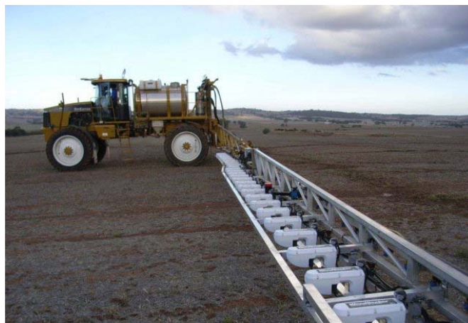
Рис. 2. Загальний вигляд агрегату з сенсорами WeedSeeker
