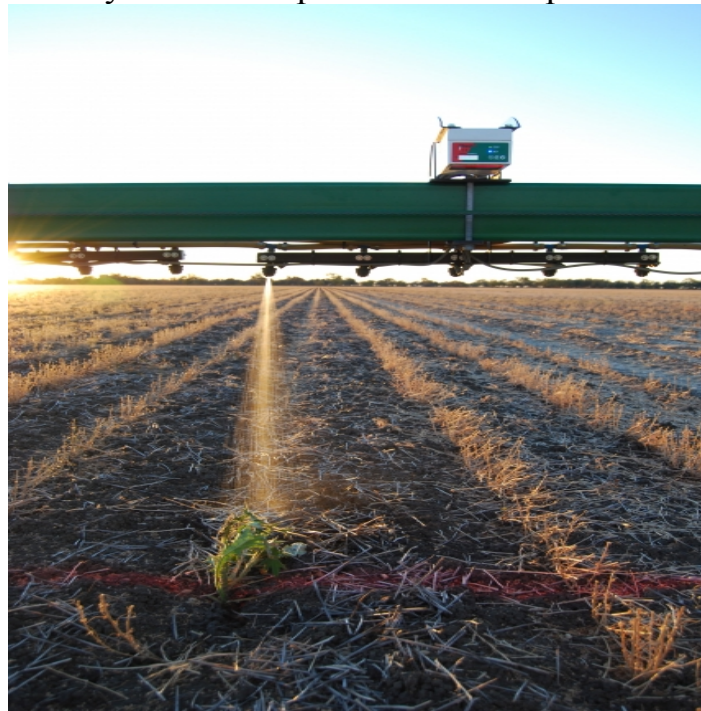
Рис 7. Система WEEDit AG в роботі
