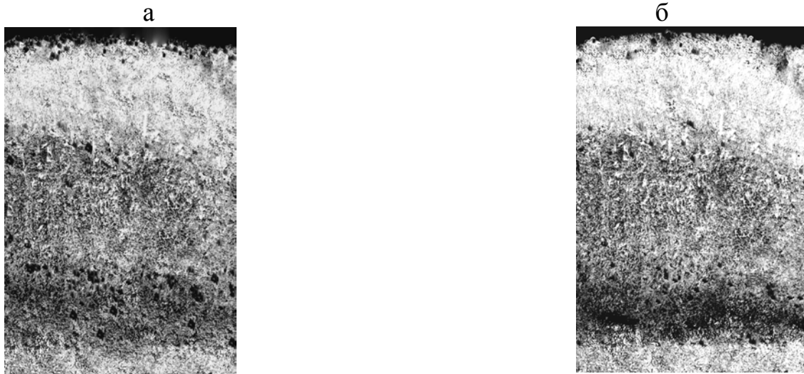
Рисунок 4 – Фотографії пористої мікроструктури покриттів, отриманих наплавкою композиційного порошку Fe – Ti ( \times 200 ) з використанням установок з МС на ЕМ (а) і ПМ (б)
