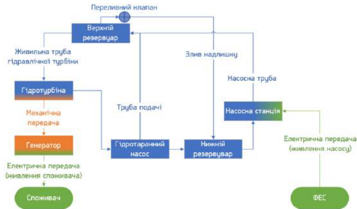
Рисунок 1 – Блок-схема автономної гідроакumuлюючої установки з замкнутим циклом використання робочого тіла
