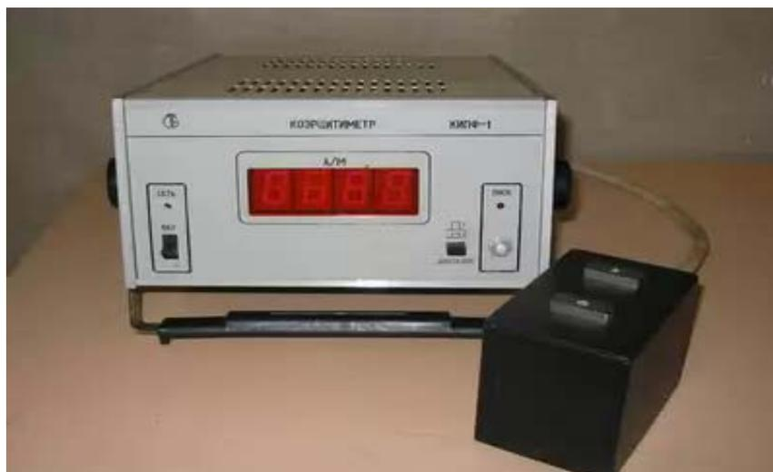
Рисунок 3 - Внешний вид коэрцитиметра КИПФ-1
