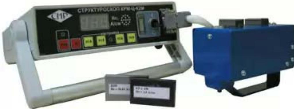
Рисунок 5 - Внешний вид коэрцитиметра КРМ-Ц-К2М
