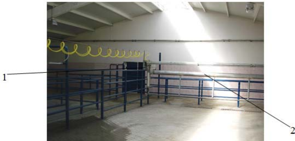
Рис. 1. Механічний підгонщик доїльної установки “Вou Matic”: 1 – виконавчий механізм підгонщика; 2 – підгонщик, виконаний у вигляді труби
