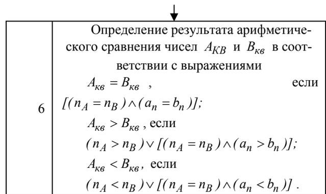
Рисунок 4 – Метод арифметического сравнения двух чисел в КВ
