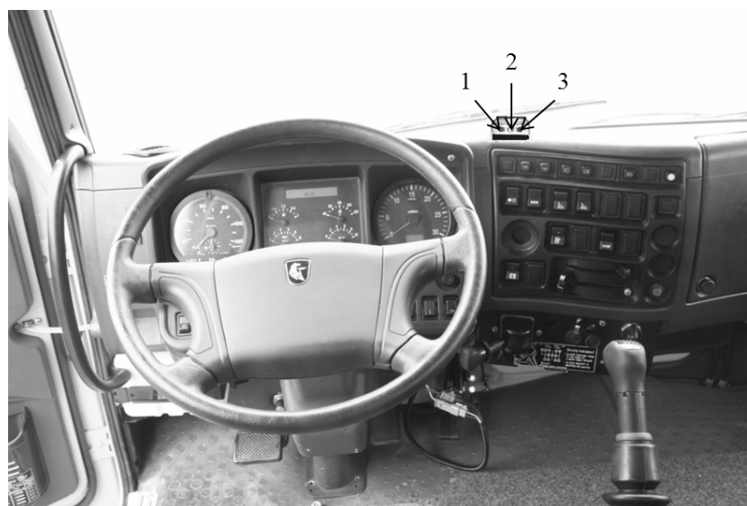
Рис.5. Контроль за состоянием давления и количества картерных газов водителем из кабины автомобиля: 1 – (зелен.) – норма; 2 - (желт.) - давл.газов превыш. на 40%; 3 – (красн.) – давл.газов критич.
