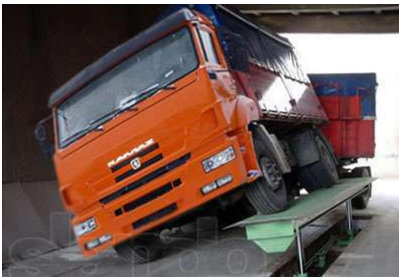
Рис.17 розвантаження зерна крізь бічний борт.
