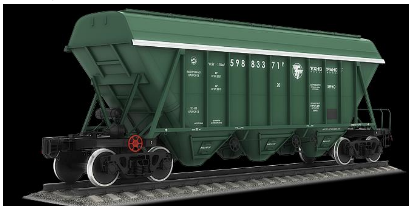
Рис. 4. Вагон-зерновоз вантажопідйомністю 65 т.
