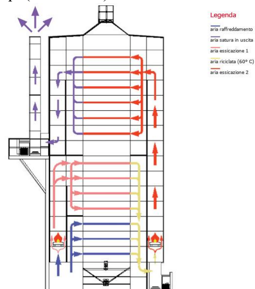
Рис. 5. Розподілення теплого повітря по зерносушарці, з частковою рециркуляцією.
