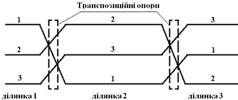
Рисунок 4 – Схема циклу транспозиції фаз повітряної лінії: 1 – фаза А; 2 – фаза В; 3 – фаза С.
