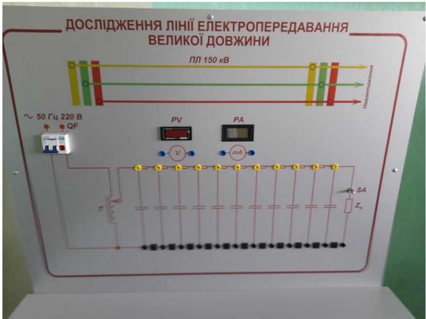
Рисунок 8 – Модель лабораторної установки.
