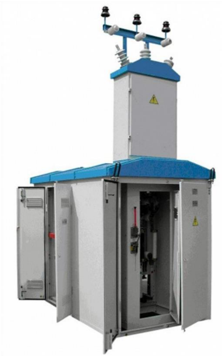
Рисунок 3 - Тупикова трансформаторна підстанція серії GENET PLATINUM ELECTRIC КТП-1 630/(6)10/0,4 з повітряним введенням.
