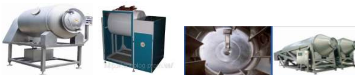
Рисунок 4.4 – Приклад обладнання для вакуумного масажування м'яса
