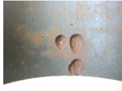
Рис.1 - Фрагменты резьбового соединения (слева) и тела НКТ с критической степенью поврежденности
