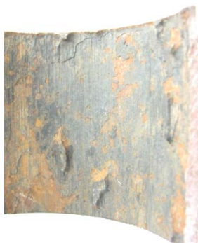
Рис.2 - Участок тела трубы с сильной степенью поврежденности
