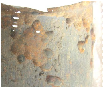
Рис.1 - Фрагменты резьбового соединения (слева) и тела НКТ с критической степенью поврежденности
