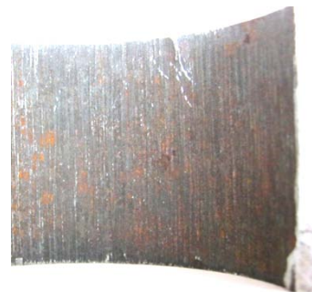
Рис.3 - Участок тела трубы с умеренной степенью поврежденности
