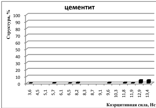
Рис. 5 – Зависимость цементит-коерцитивная сила в исследуемых втулках цилиндров
