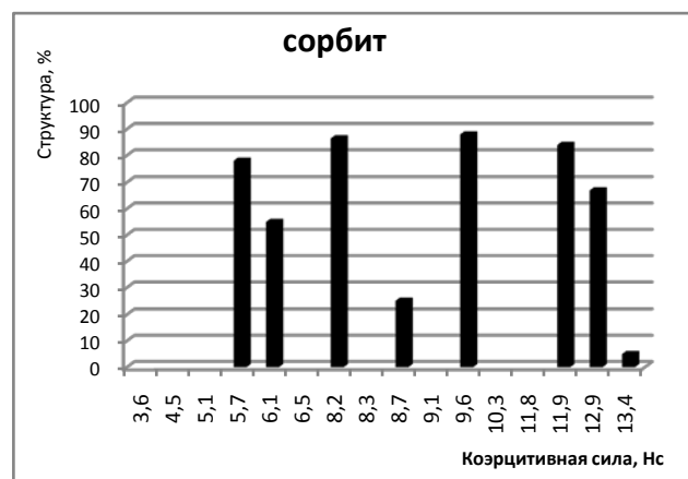
Рис. 4 – Зависимость сорбит-коэрцитивная сила в исследуемых втулках цилиндров
