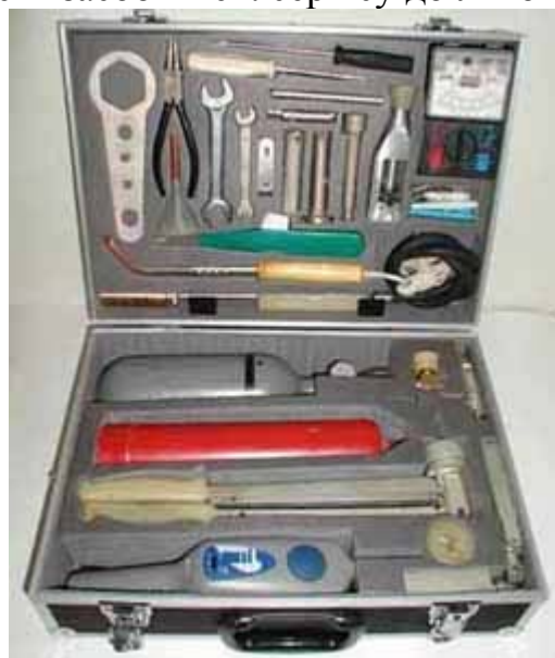
Рис.1. Переносний комплект засобів технічного сервісу доїльного обладнання КИ-28030
