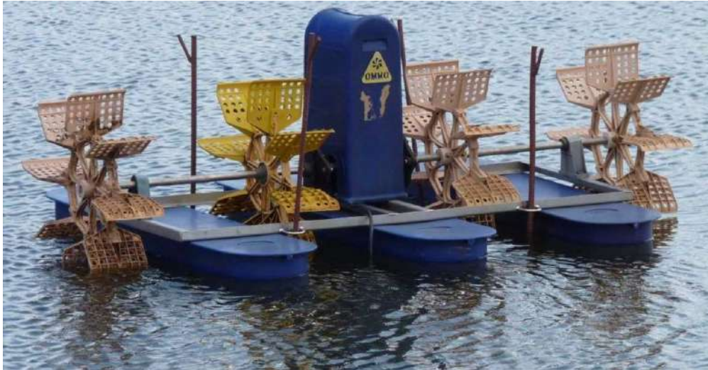
Рис. 2.30. Аератор для ставка
