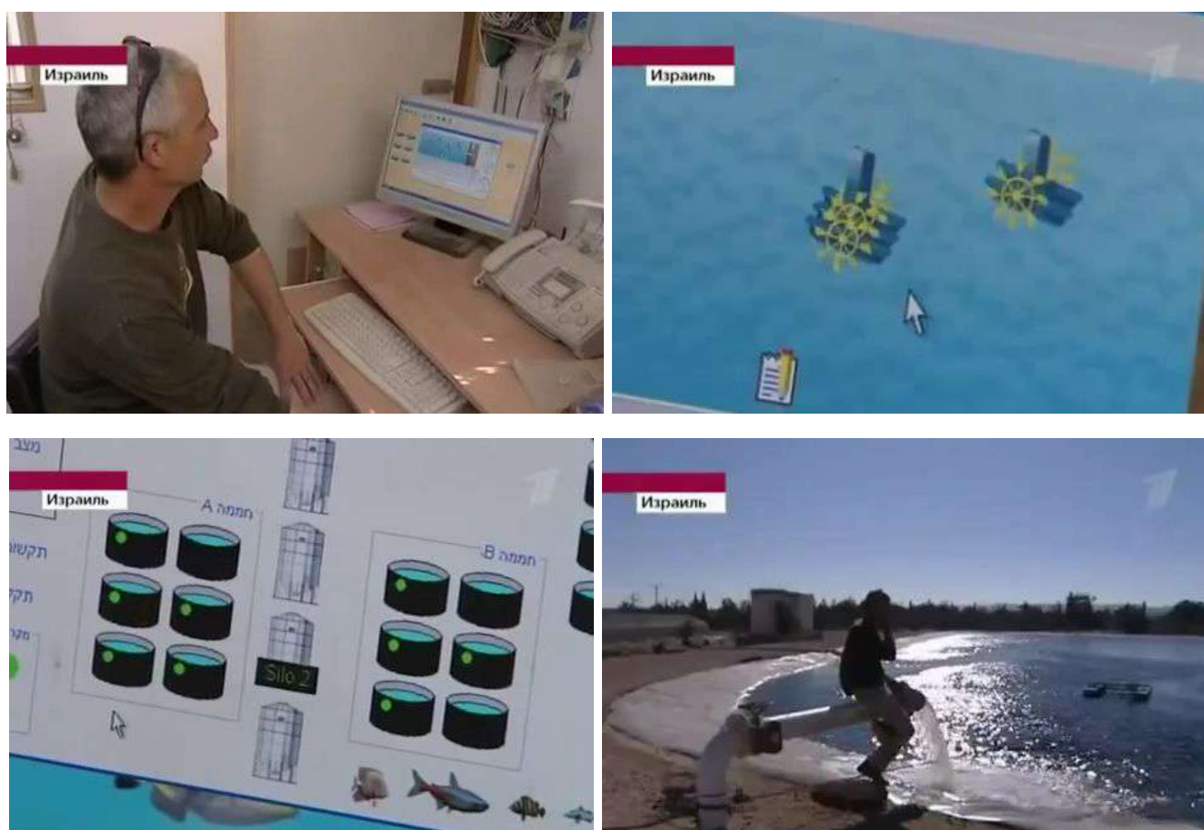
Рис. 5. Хімічний склад води щоденно аналізує комп'ютер, котрий за потреби накачує нову воду з надр, а використану скидає відпочити у викопане відкрите море викопане поруч (у водоймі розмножуються спеціальні бактерії, які очищують воду від азотистих сполук і знову насичують воду киснем)
