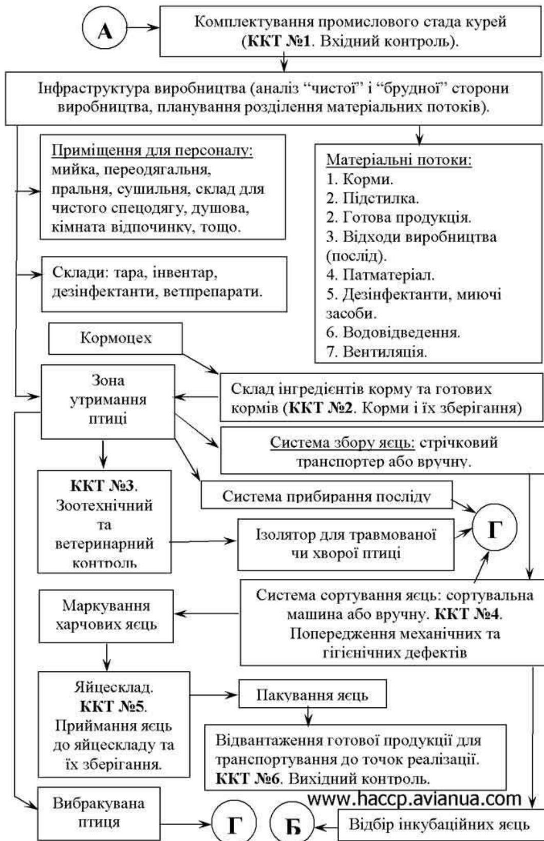
Рис.26. Блок–схема технології виробничих процесів цеху утримання дорослої птиці і ККТ моніторингу факторів, що впливають на безпеку продукції згідно принципів системи НАССР
