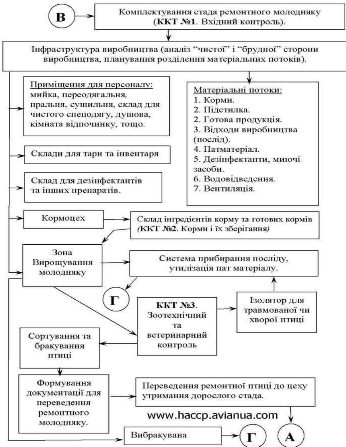
Рис.27. Блок-схема технології виробничих процесів цеху вирощування ремонтного молодняку курей і ККТ моніторингу факторів, що впливають на безпеку продукції згідно принципів системи НАССР
