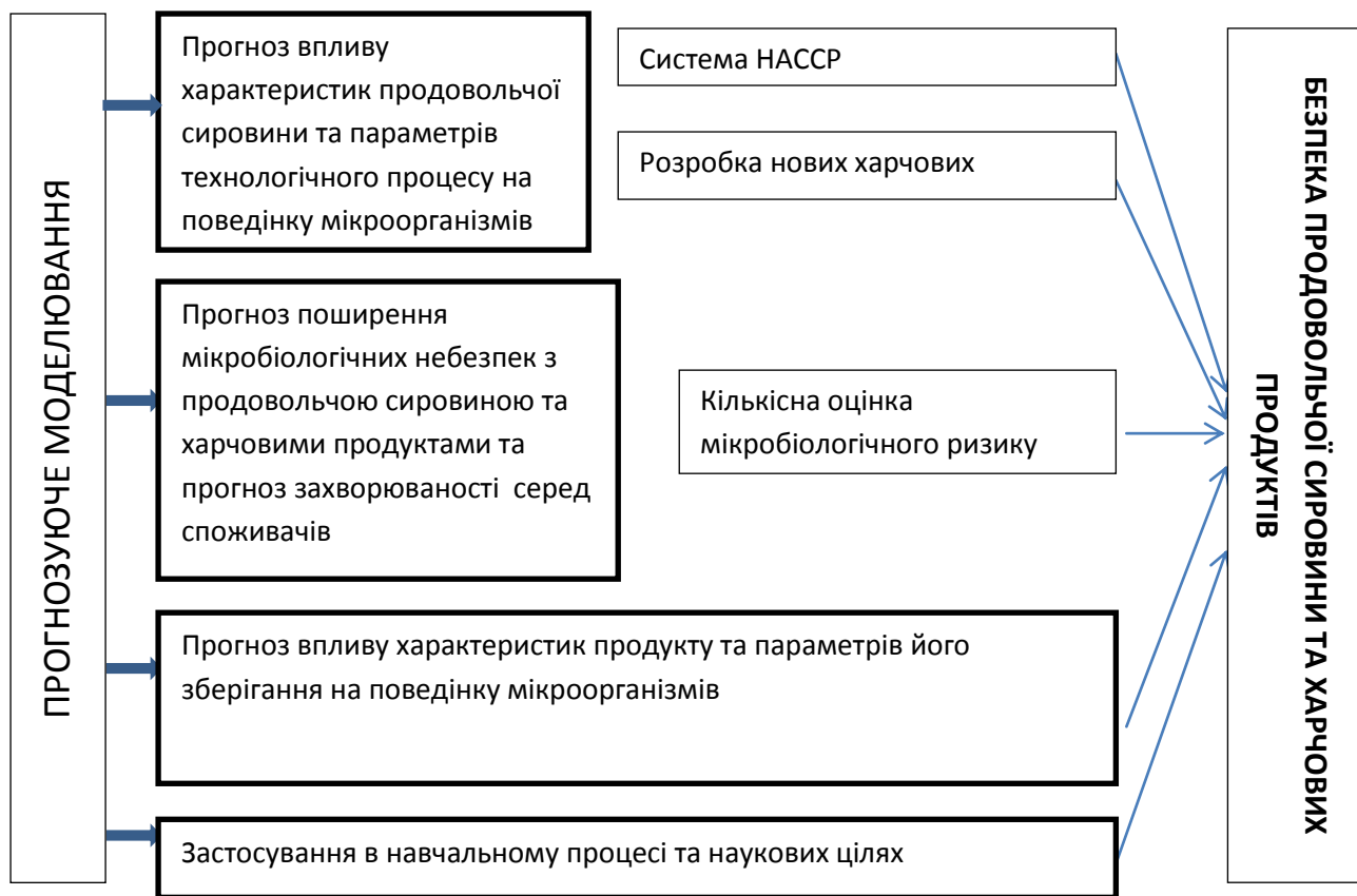
Рис. 20. Застосування прогнозуючого моделювання в контролі за мікробіологічними небезпечностями в продовольчій сировині та харчових продуктах
