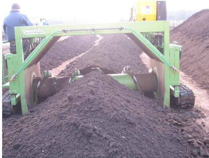
Рис. 4.4. – Процес механізованого перемішування бурта компосту
