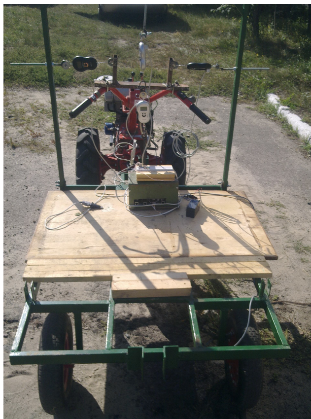
Рис. 3. Общий вид измерительного комплекса усилий на штангах управления мотоагрегата.
