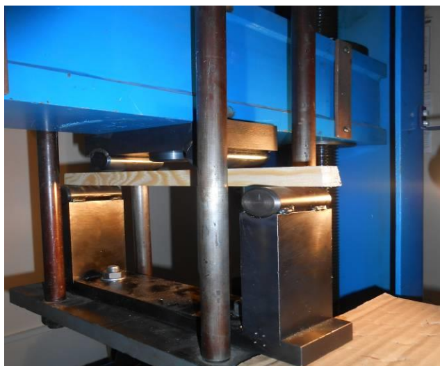
Рисунок 4 – Схема навантаження зразка під час випробуванні на статичний згин
