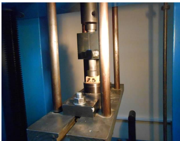
Рисунок 3 – Випробування зразків деревини на стиск поперек волокон
