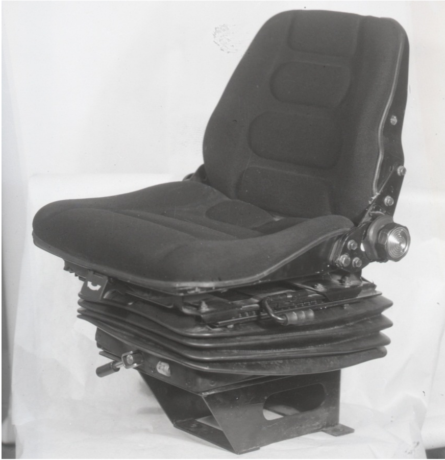
Рис. 3 – Сидіння оператора фірми "Грамммер" моделі DS 85/90
