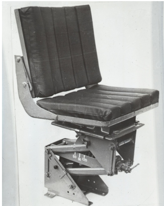
Рис. 1 – Серійне уніфіковане сидіння водія трактора Т-150К конструкції ХТЗ
