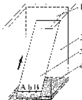
Рисунок А.1 – Хроматографічна камера з пластинкою із закріпленим шаром сорбенту: 1 – кришка; 2 – камера; 3 – пластинка; 4 – елюент
