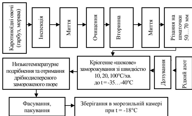
Рисунок 1 – Технологічна схема виробництва наноструктурованих заморожених поре з каротиноїдних овочів (морква, гарбуз) з використанням кріогенного заморожування та низькотемпературного подрібнення
