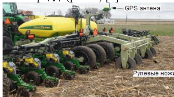
Рисунок 1 – Активне управління сівалкою на бічному схилі
