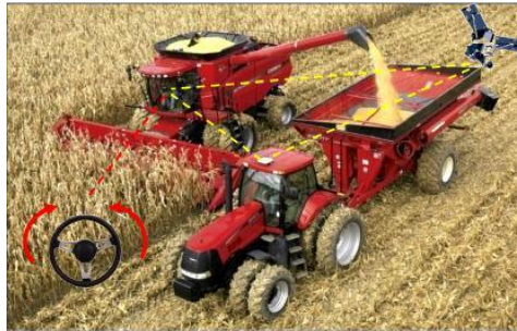
Рисунок 1 – Синхронізація роботи машин за допомогою системи V2V
