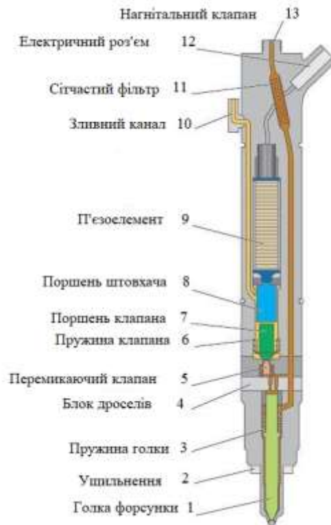
Рис.4 П'єзоелектрична форсунка
