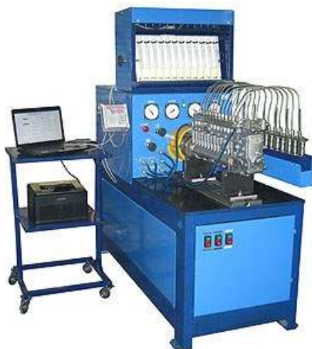
Рис.2 Стенд СДМ-12-03-7,5 CR-Standart має 12 секцій, привід потужністю 7,5 кВт, оснащується: системою подачі палива високого та низького тиску; системою термостабілізації; комп'ютерною системою управління з базою даних з форсунок Common Rail та паливних насосів - СДМ-КС стандартним комплектом CR (для перевірки систем Common Rail).
