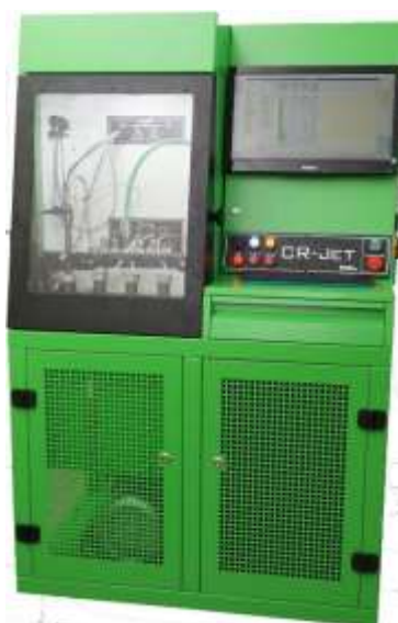
Рис.3 Стенд CR-JET Дизельний стенд для ремонту та перевірки кодування форсунок Common Rail BOSCH, DELPHI, DENSO, SIEMENS
