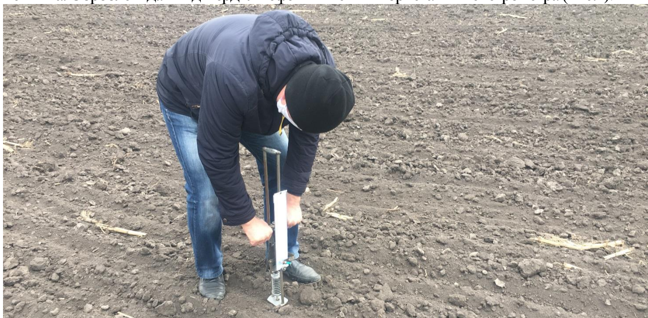
Рис. 2. Заміри щільності ґрунту з використанням твердоміра Ревякіна
