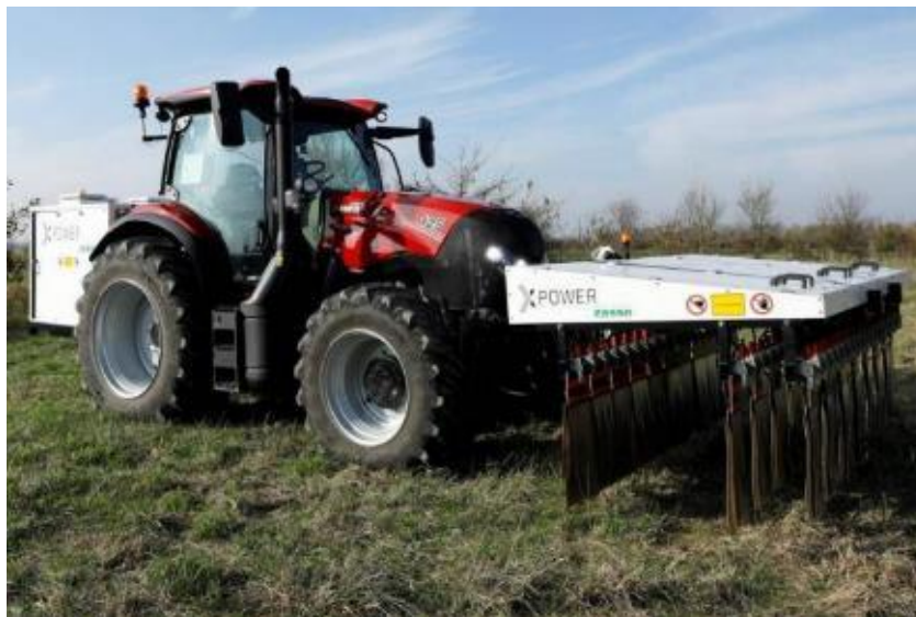
Рис. 1. Система знищення бур'янів електричним струмом Case Ih Xpower
