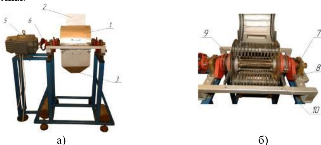
Рисунок 1 – Вібродискова дробарка [2]: а) загальний вигляд; б) виконавчий орган; 1 – корпус; 2, 3 – завантажувальна та розвантажувальна горловина; 4 – сито (на рисунку не показано); 5 – електродвигун; 6 – муфта еластична; 7 – вал кінематичний; 8 – противаги; 9 – ротор; 10 – біла дисковидні.
