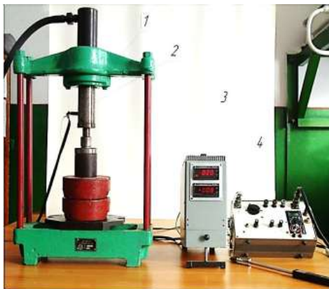
Рисунок Загальний вигляд обладнання для визначення зусилля під час розбирання і складання підшипникових вузлів: 1 – гідропрес; 2 – шток з тензOMETричним давачем; 3 – аналого-цифровий перетворювач; 4 – підсилювач сигналу тензOMETричного давача
