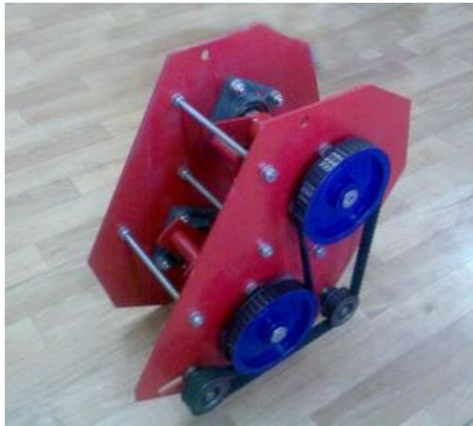
Рисунок 2 – Вібробудник прямолінійних коливань двовального типу з ремінною зубчастою передачею
