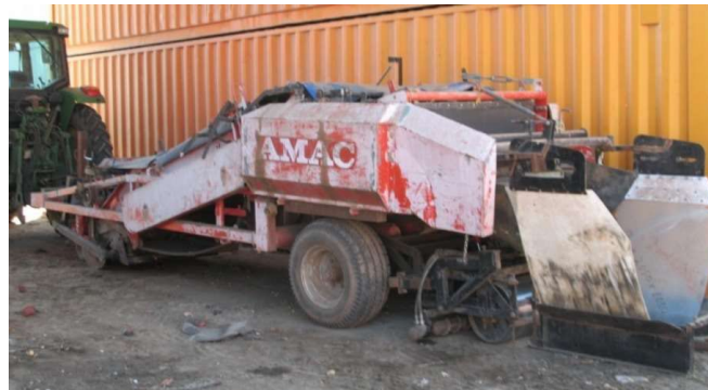
Рис. 1 – Загальний вигляд машини для збирання цибулі-сіянки, оснащеної роликівим сепаратором відділення цибулин від ґрунтових домішок (вигляд збоку).
