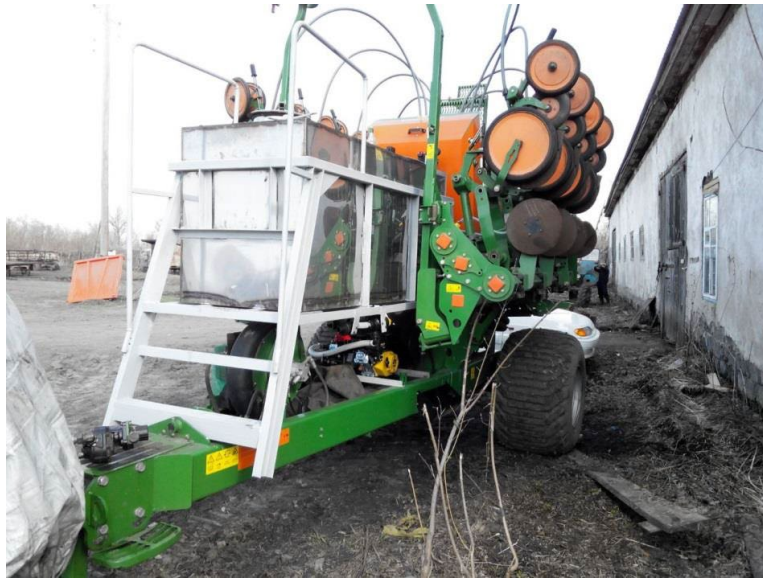
Рис. 3 – Модернізована сівалка EDX-6000, обладнана для внесення рідких добрив
