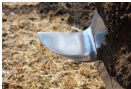
Рис. 1 – Типова поверхня тертя робочих органів ґрунтообробних машин (робочі органи фірми «Веднар FMT», напрацювання агрегату 130 га, Попільнянський район Житомирська область)
