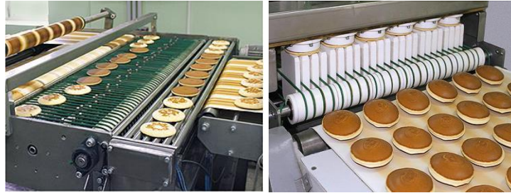
Рис. 4. Ділянка технологічної лінії виробництва кондитерських виробів «ПанКейк» з сирною начинкою (промислове виробництво на ТОВ ПКГ «Лісна казка», м. Харків)
