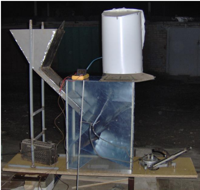
Рис. 1. Лабораторна установка з завантажувальним пристроєм і каскадами прямокутної форми
