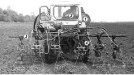
Рис. 14. Агрегат для стрічкового внутрішньогрунтового внесення гербіцидів: 1 — підживлювач-обприскувач ПОМ-630; 2 — трактор ЮМЗ-6; 3 — культиватор КРН-4,2; 4 — щілювач-направлювач
