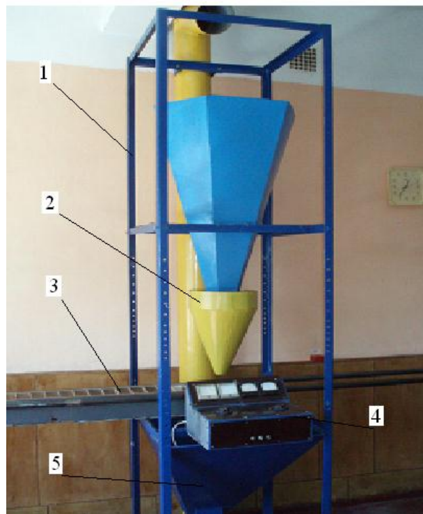
Рис. 9. Загальний вигляд експериментальної установки для дослідження процесу дозування-змішування сипких матеріалів: 1 – рама; 2 – дозатор-змішувач; 3 – пробовідбірник; 4 – контрольно-вимірювальний комплекс; 5 – накопичувальний бункер
