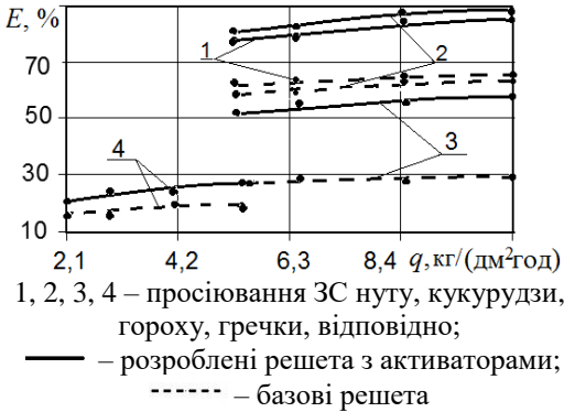
Рисунок 12 – Залежності повноти розділення ЗС на плоских віброрешетах від їх питомого завантаження
