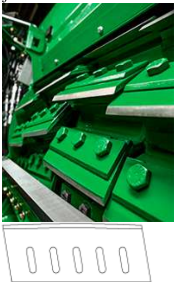
Зовнішній вигляд різального барабану і схематичне зображення його елемента (ножа)
