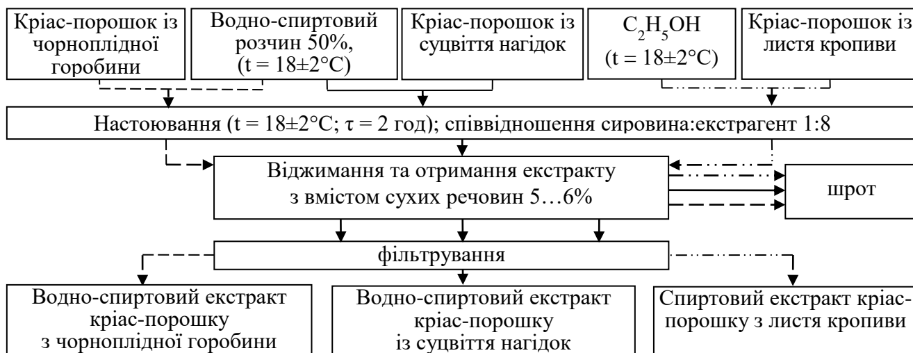
Рис. 2. Технологічна схема екстракції дрібнодисперсних кріас-порошків із антоціанової, каротиновмісної і хлорофіловмісної рослинної сировини
