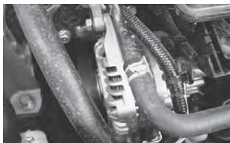
**У генератора 37.3701** для шунтирования неисправного регулятора напряжения клемму «30» соединяют с клеммой «В» генератора, а внутреннюю щетку — с корпусом генератора.
